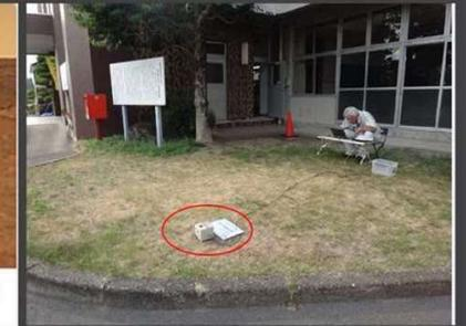
2003年 中電技術コンサルタント (山大三浦先生紹介) の協力業務で山口県内300か所の官庁施設の地盤調査 (常時微動計測) を担当。計測した振動波形と地層構造に関係性を見出し地盤調査業務に活用。ボーリング柱状図とHV/Sヘルム波形状との関連付けを行い特許取得。
